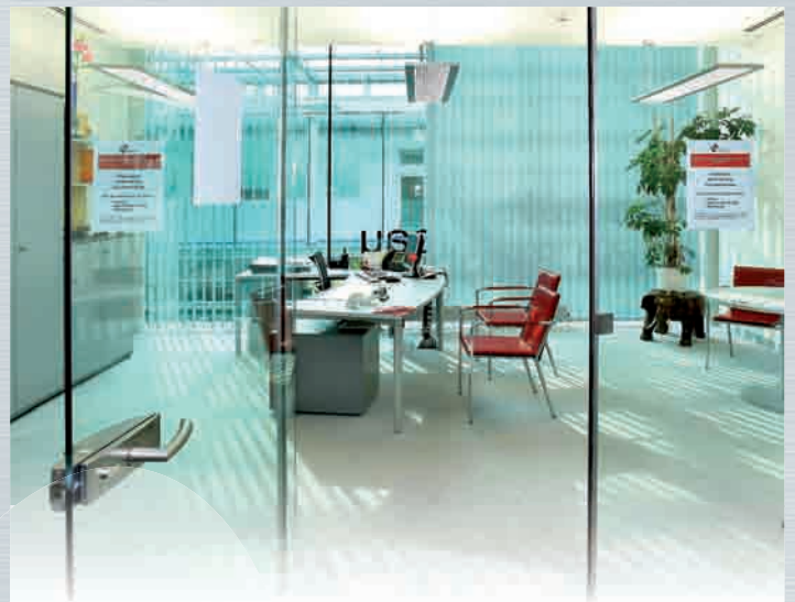
Nurglaswand mit Edelstahlbeschalg und Dichtungsprofilen
